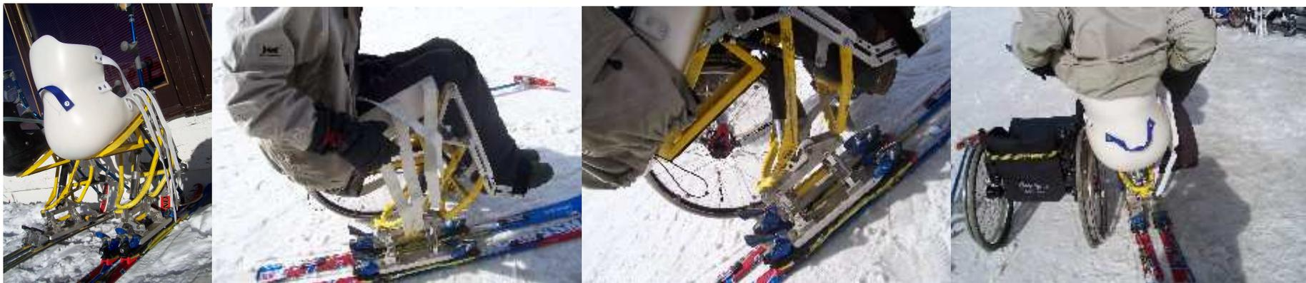
Il y a une coque moulée (sur mesure du Bastos), montée sur un châssis jaune qui s'enclenche dans les fixations du ski,
